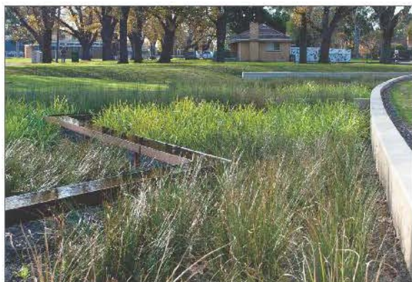
Exempel på långsmal fördröjningsdamm.
