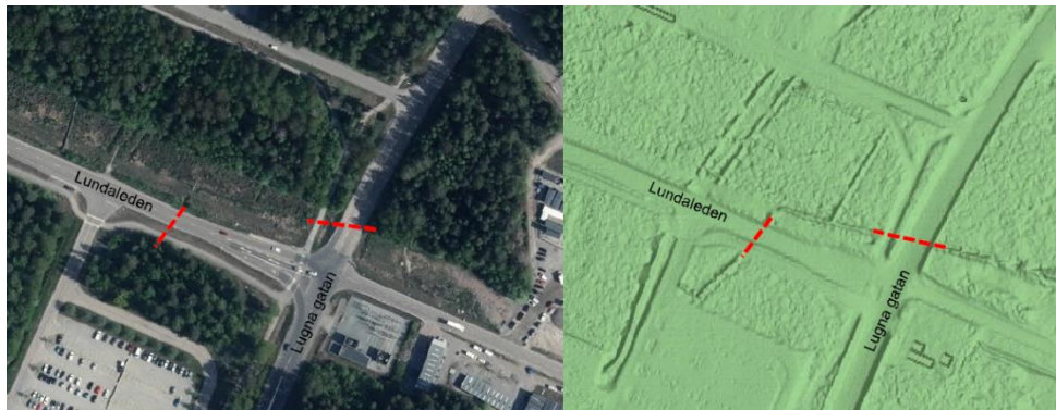
31 Befintligt dike i planområdets östra del. Ortofoto från Lantmäteriets vigningstjänst (vänster bild). Lantmäteriets markhöjmodell 1x1 m visas i höger bild. Antagna vägtrummor markeras med röda streckade linjer. Källa: Sweco
